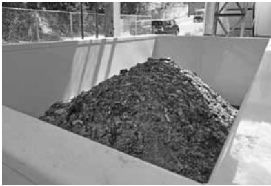
排出された焼却灰の山
