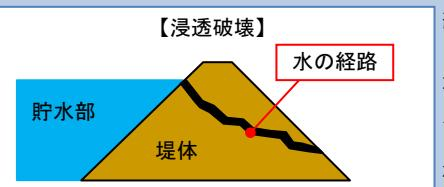
経年変化でため池の堤体内に浸透する水の経路が生まれます。豪雨で貯水位が急上昇すると、堤体内の水圧も上昇して強度が低下し、破壊する場合があります。
