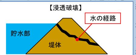
経年変化でため池の堤体内に浸透する水の経路が生まれます。豪雨で貯水位が急上昇すると、堤体内の水圧も上昇して強度が低下し、破壊する場合があります。
