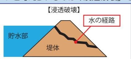
経年変化でため池の堤体内に浸透する水の経路が生まれます。豪雨で貯水位が急上昇すると、堤体内的水圧も上昇して強度が低下し、破壊する場合があります。
