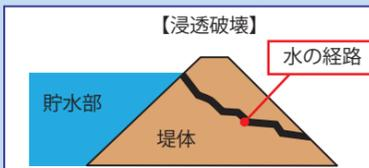
経年変化でため池の堤体内に浸透する水の経路が生まれます。豪雨で貯水位が急上昇すると、堤体内の水圧も上昇して強度が低下し、破壊する場合があります。
