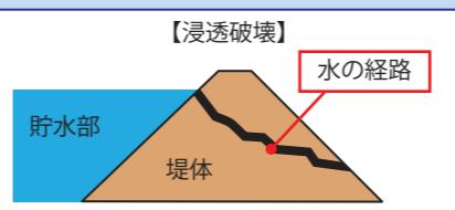
経年変化でため池の堤体内に浸透する水の経路が生まれます。豪雨で貯水位が急上昇すると、堤体内の水圧も上昇して強度が低下し、破壊する場合があります。
